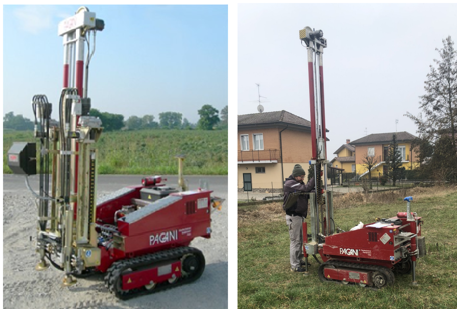
Figura 6 - Modello Penetrometro superpesante per prove dinamiche.
